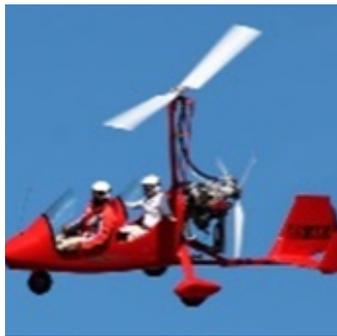
Classe 4 L'Autogire, aussi connu sous le nom de gyrocoptère, est un type d'ULM avec une voilure tournante mais il est propulsé par un moteur et son rotor principal est non propulsé. Le rotor principal tourne grâce à la force du vent relatif lors du vol.
