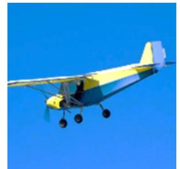
**Classe 3 Le Multiaxe** a une configuration similaire à celle d'un avion traditionnel, avec des ailes fixes, un fuselage, une queue et des gouvernes de contrôle. Ils offrent une grande maniabilité et une vitesse de croisière plus élevée par rapport à d'autres catégories d'ULM.
