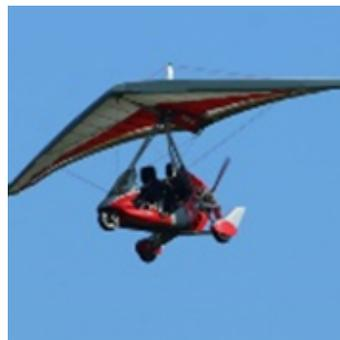
**Classe 2 Le Pendulaire** a une aile delta et un chariot suspendu sous la voilure, où se trouvent le pilote et le moteur. Le contrôle de l'ULM pendulaire se fait en déplaçant le centre de gravité à l'aide d'un système de commande pendulaire.
