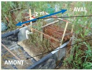
La « surface naturelle testée » mesure de 2 à 2,5 m<sup>2</sup>. Les mesures d'infiltration y sont faites. Les 4 premiers mètres de la « placette » sont rendus étanches par la mise en place d'une bâche. Un soin tout particulier est apporté à la maîtrise des pertes latérales, des pertes par la présence de galeries et des écoulements préférentiels.
