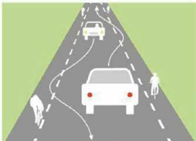
Principe de fonctionnement d'une CVCB
