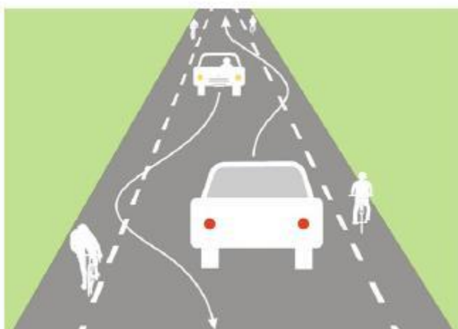
Principe de fonctionnement d'une CVCB
